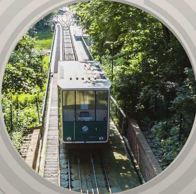
Le funiculaire de Petřín possède une longue histoire, il a été mis en service pour la première fois à Prague en 1891. En 1932, un moteur électrique a remplacé le vieux mécanisme de traction à eau. Aujourd'hui encore, le système électrique a été maintenu.
